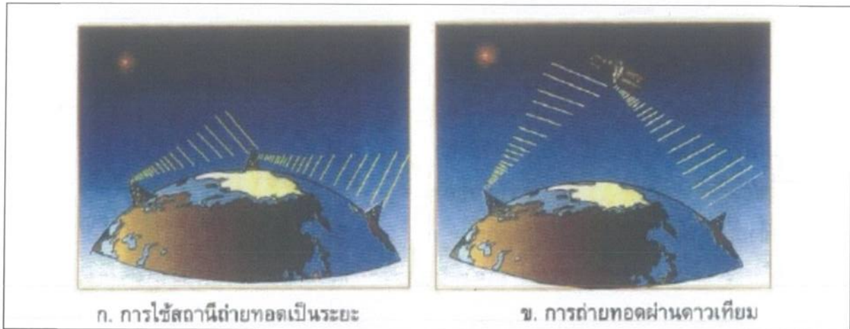
รูปที่ 4.4.5-2 ลักษณะการถ่ายทอดสัญญาณโทรทัศน์
